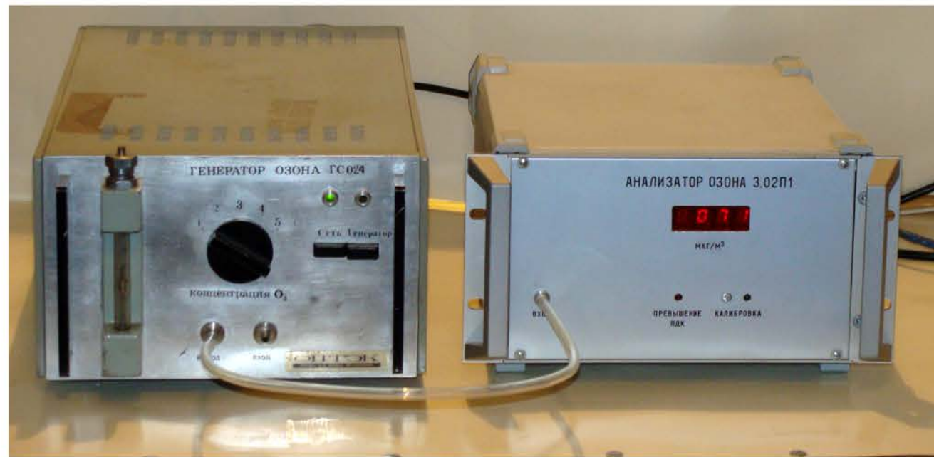
Хемилюминесцентный озонотметр «ОПТЭК» и генератор озона для калибровки.
