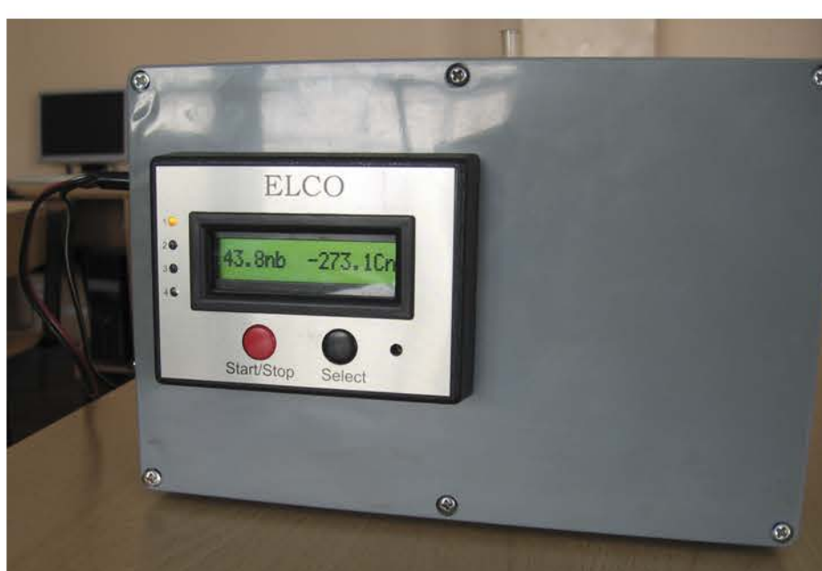
Электрохимический озонотметр «ELCO». Благодаря небольшой массе и размеру используется при полевых измерениях
