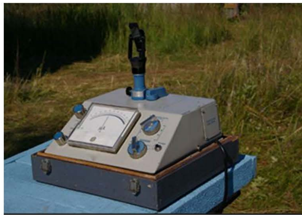
М-124 — стандартный сетевой прибор для измерения общего содержания озона и ультрафиолетовой радиации
